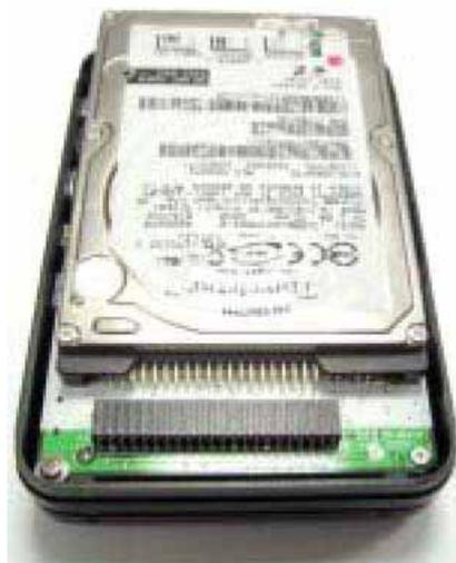
Step 3:最後にカバーをして先程外したねじをとめます。組立後ハードディスクの初期化を行ってください。
